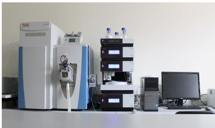
UltiMate 3000 / Q-Exactive (Thermo Fisher Scientific), un cromatograf lichid de ultra înaltă performanță cuplat cu un spectrometru de masă de înaltă rezoluție (U-HPLC/HRAM MS).
