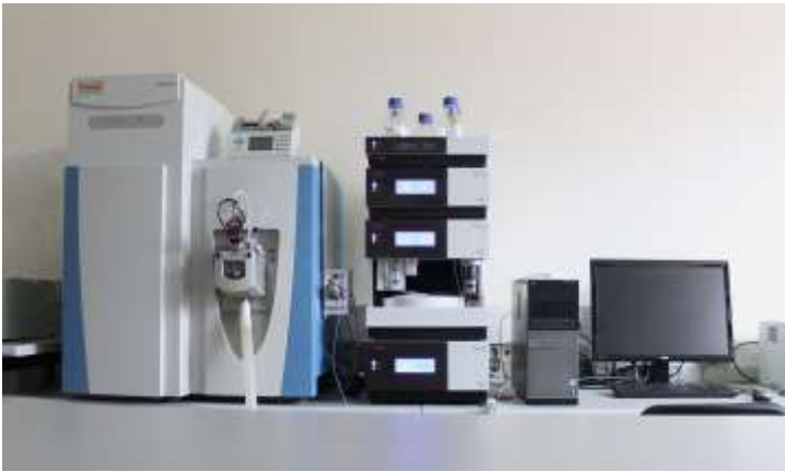
UltiMate 3000 / Q-Exactiva (Thermo Fisher Scientific), un cromatograf lichid de ultra înaltă performanță cuplat cu un spectrometru de masă de înaltă rezoluție (U-HPLC/HRAM MS).
